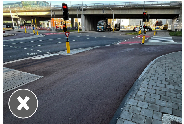
Bypass voor fietsverkeer die zeer veel ruimte inneemt t.o.v. de voetgangersinfrastructuur.
