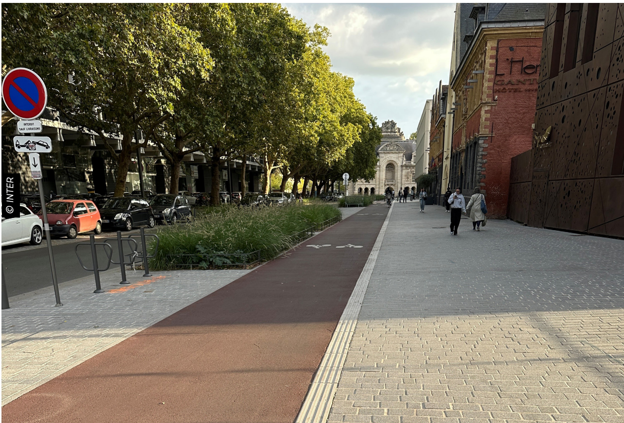
Een redresseerzone die visueel en tactiel herkenbaar is.
