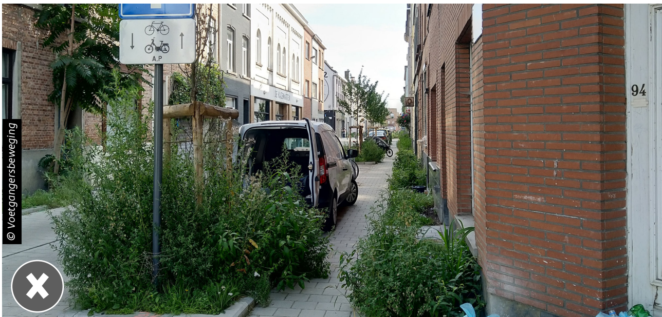
De obstakelvrije loopruimte tussen de plantvakken is te smal en overhangend groen verkleint de doorgang nog verder.
