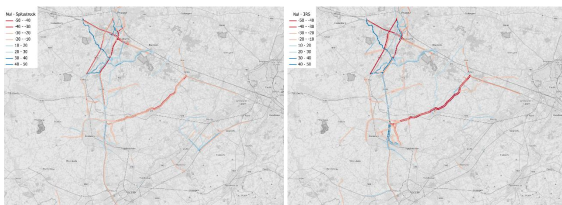
Figuur 5-3: Aantal vrachtwagens per dag in het alternatief met spitsstrook (links) en in het alternatief met 3 rijstroken (rechts) ten opzichte van het nulalternatief. Rood geeft aan dat het dagelijks verkeer op de link toeneemt, blauw dat het dagelijks verkeer af.
