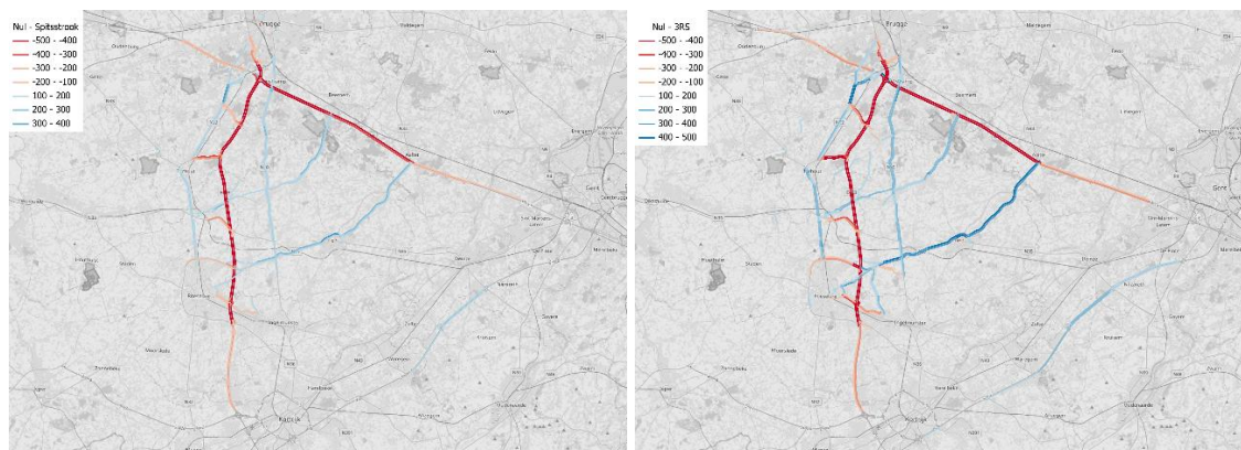
Figuur 5-2: Aantal personenwagens per dag in het alternatief met spitsstrook (links) en in het alternatief met 3 rijstroken (rechts) ten opzichte van het nulalternatief. Rood geeft aan dat het dagelijks verkeer toeneemt, blauw dat het dagelijks verkeer afneemt.
