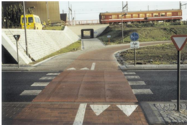
Foto 2.6: Fietsroute naar station (Opgelet: de rode inkleuring van de fietsoversteek uit de voorrang is NIET conform!)
