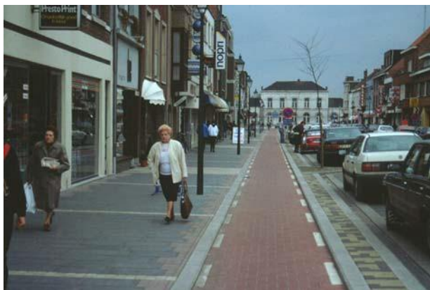
Foto 3.18 Strook tussen vrijliggend fietspad en parkeerstrook – Leopoldsbury
