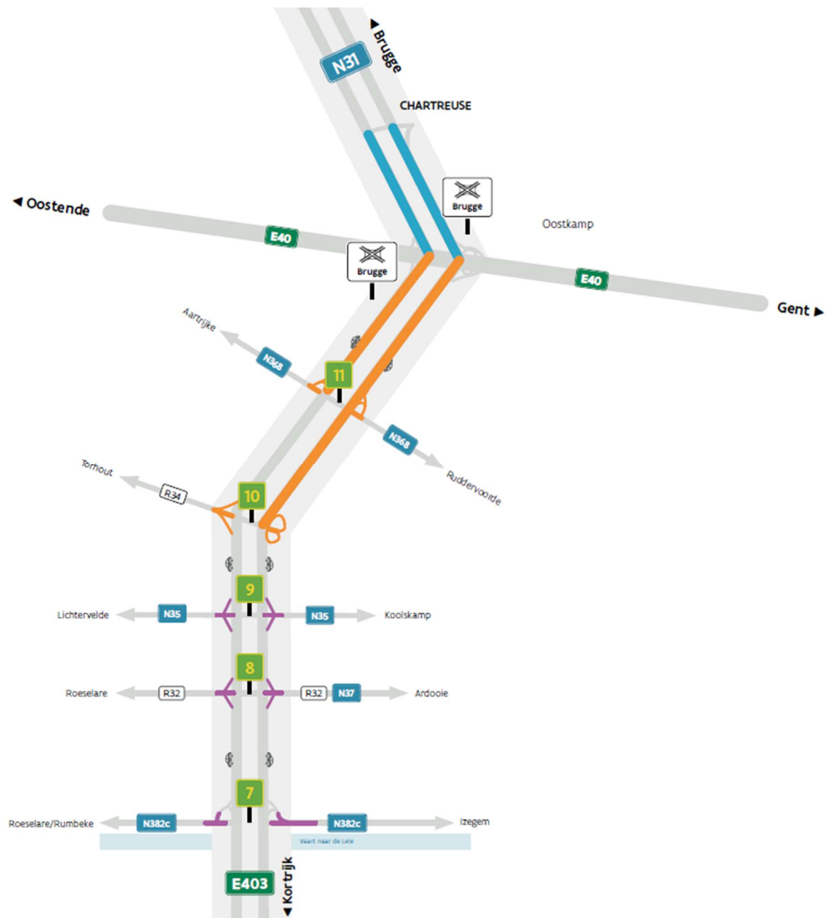
Figuur 7 - schematische voorstelling voorkeursoplossing (blauw: weefzone, oranje: zone spitsstroken, paars: op- en afritcomplexen)
