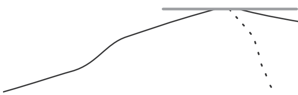
figuur 64: Verticale S-vorm met langshelling \geq 0,5\%
