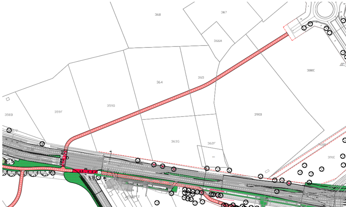
Figuur 187: Nieuw ontwerp fietsverbinding tussen kruispunt Nieuwe Verbindingsweg en Evolis
