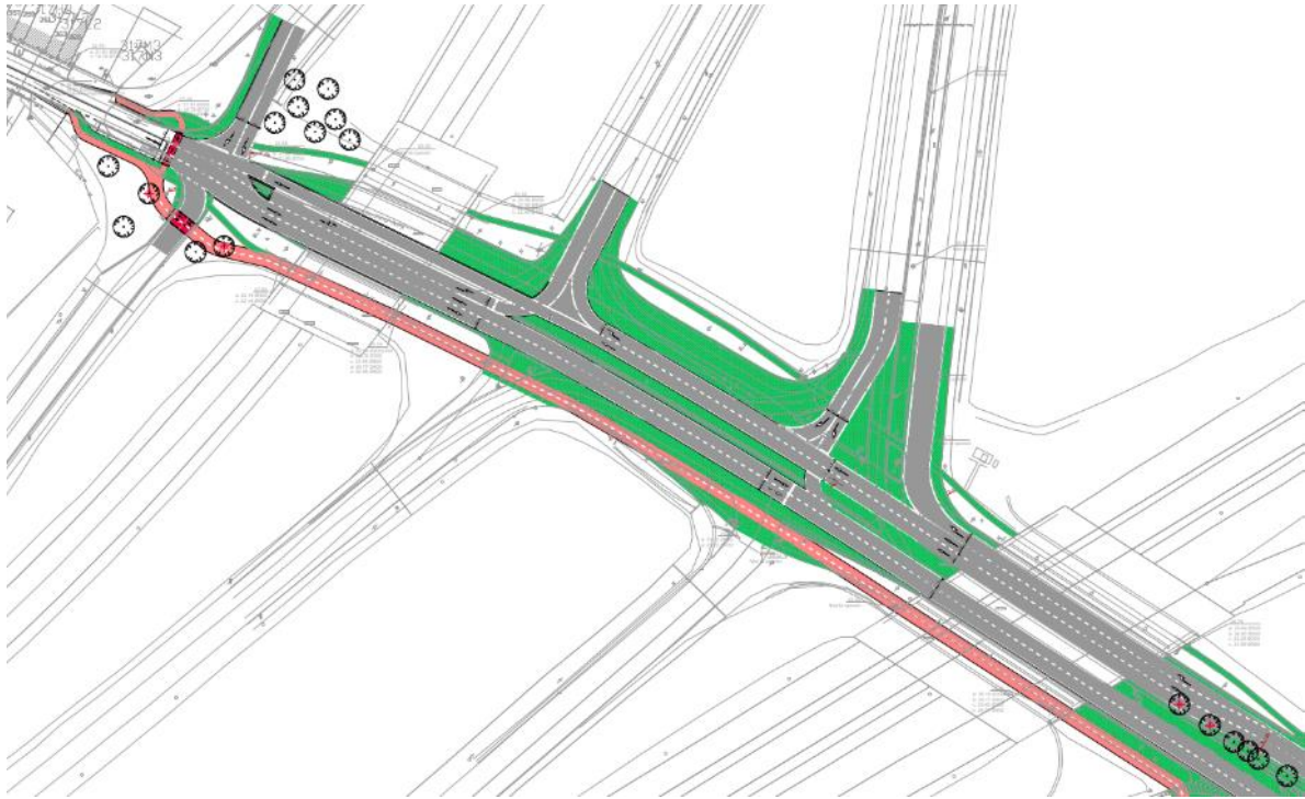
Figuur 183: Nieuw ontwerp nieuwe kruispunten aansluitingen van E17 en R8 op de N8
