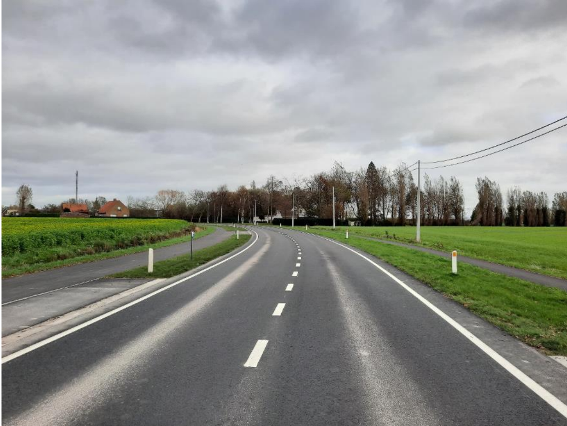
Figuur 5-13: rijweg en vrijliggende fietspaden uit asfalt (Sint-Rijkersstraat te Alveringem)
