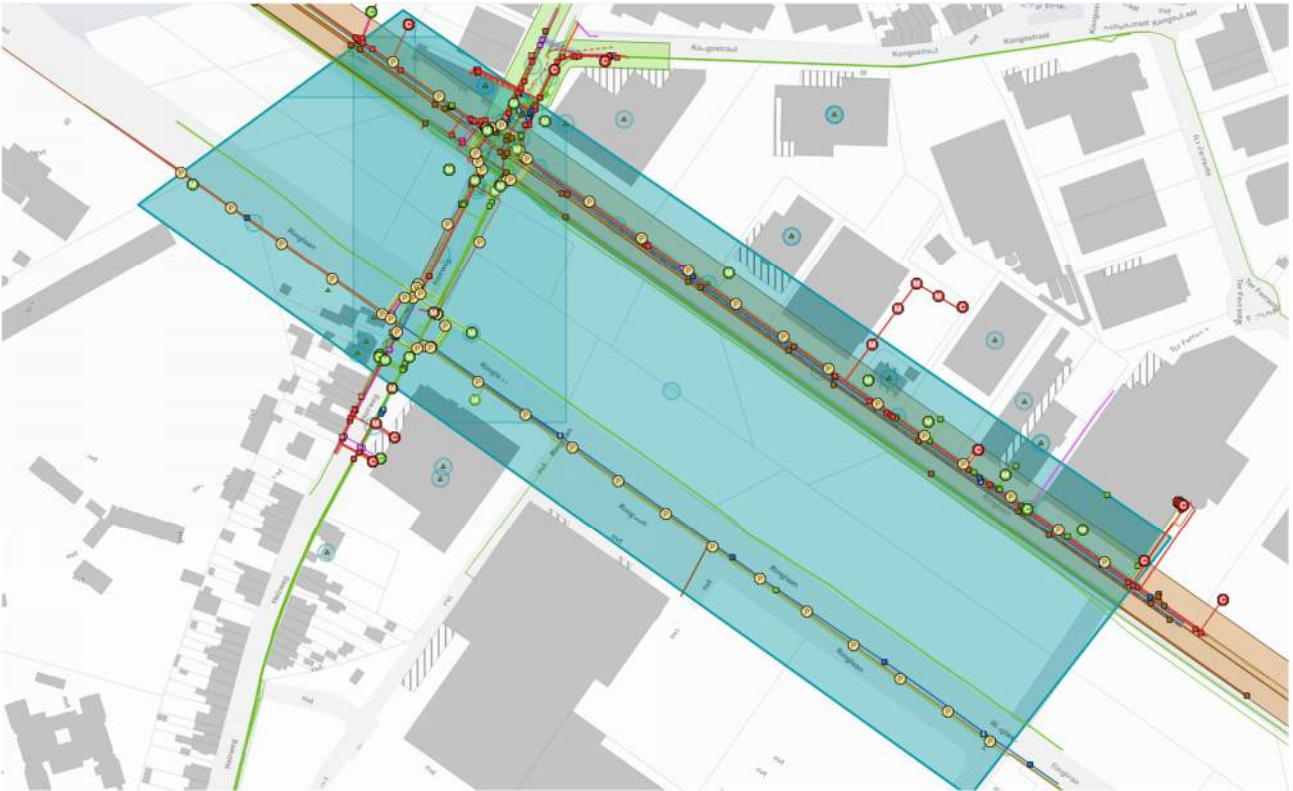
Figuur 3-8: Aanwezige nutsleidingen – Deel 3
