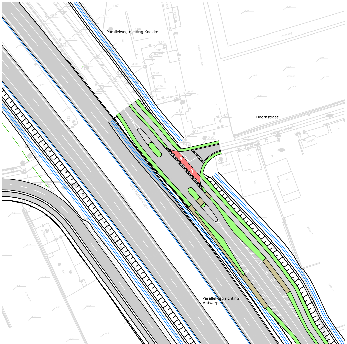
Figuur: Ombouw N49 Damme - Maldegem: uitwerking kruispunt parallelweg * Hoornstraat (oostzijde E34)
