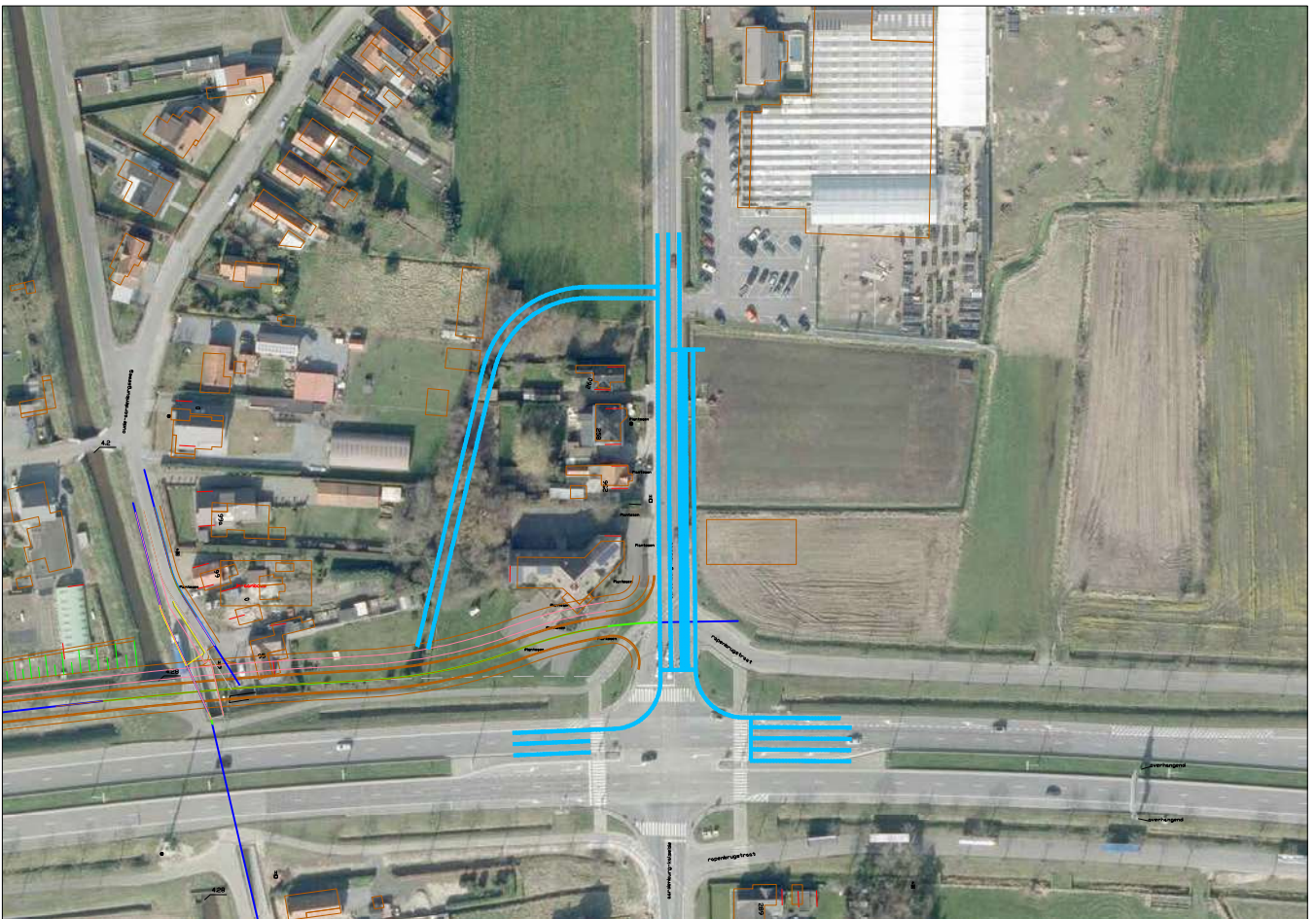
Figuur 4-3. Test uiteengelegde kruispunten: aansluiting parallelweg op de N410 – NIET WEERHOUDEN VARIANT
