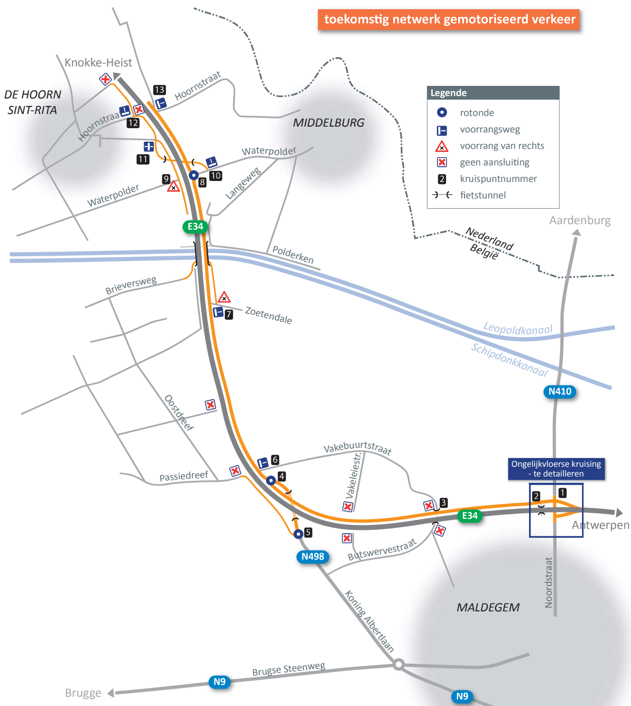
Figuur: Ombouw N49 Damme - Maldegem: netwerk gemotoriseerd verkeer
