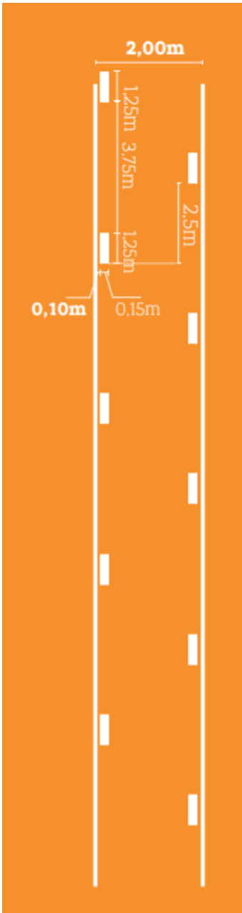
Figuur: markering enkelrichtingsfietspaden volgens uitrustingsniveau 2 (niet-verlichte fietspaden)
