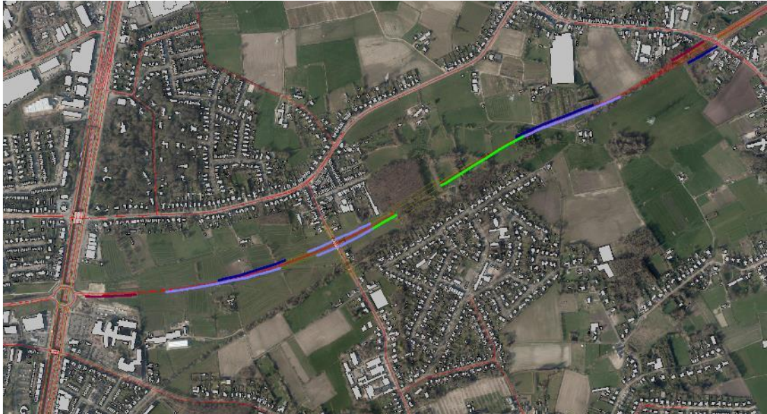
Figuur 10-65 Milderende maatregelen doorstromingsalternatief – minimaal benodigde schermhoogte
