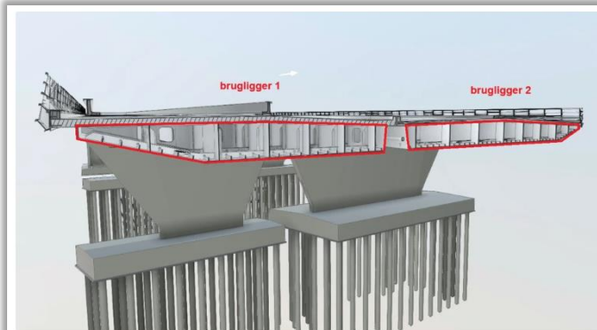
Twee afzonderlijke bruggen die elk één brugligger hebben. De brugliggers zijn op hun beurt opgebouwd uit meerdere stalen profielen en platen.
