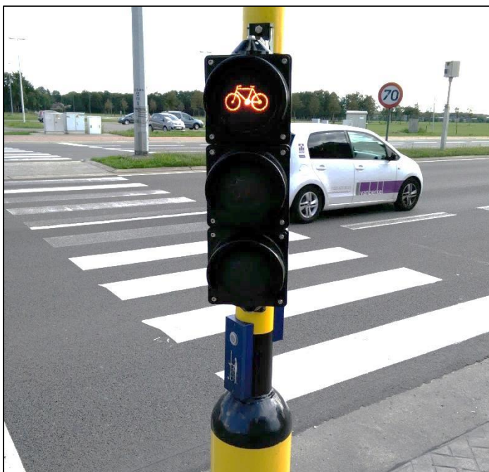
Figuur 38 Herhalingslicht op ooghoogte voor fietsers
