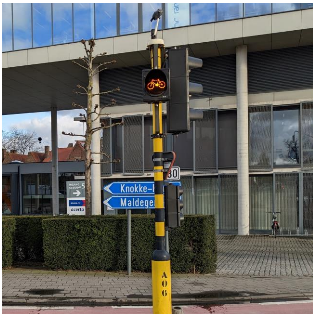
Figuur 69 Oranjegeel knipperlicht met fiets-silhouet
