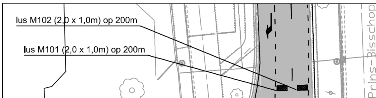
Figuur 85 Voorbeeld van de weergave van macrolussen op een V-plan
