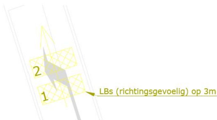
Figuur 109 Voorbeeld van een richtingsgevoelige detector
