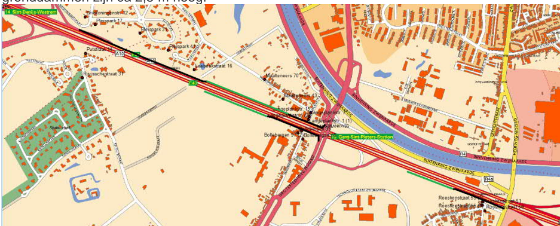
Figuur 4-12: situering bestaande geluidsafschermende constructies : zwarte lijn: geluidsscherm, groene lijn: gronddam met houtige beplanting
