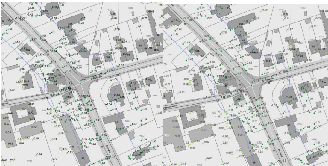
Figuur 5-18: Zoom-in verschilwaarden concentraties NO 2 voor het voorkeursalternatief vs. referentiesituatie zonder ombouw van de N42 in het noorden (links) en met ombouw van de N42 in het noorden (rechts) t.h.v. Wijnhuize kern
