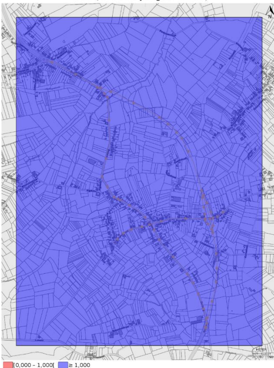
Figuur 3-10: Aantal overschrijdingen daggemiddelde grenswaarden PM 10 voor het gewestplantracé (zonder ombouw van de N42 in het noorden) volgens IMPACT berekeningen
