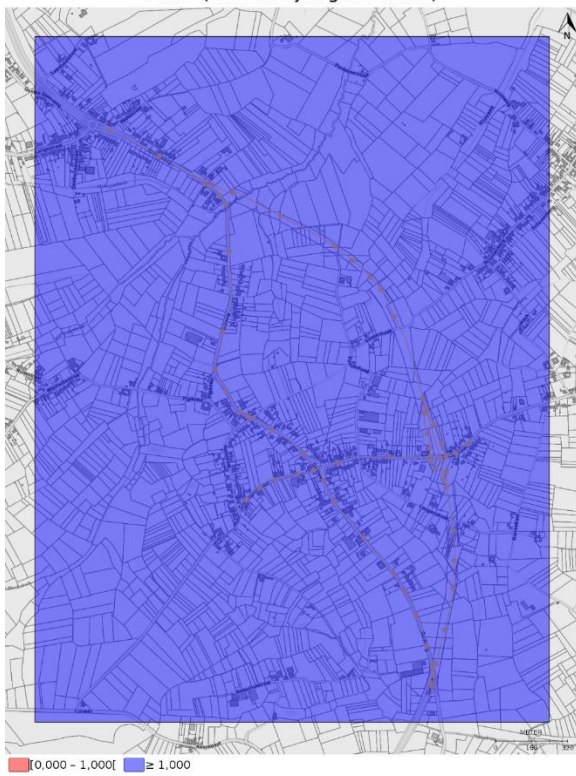
Figuur 3-14: Aantal overschrijdingen daggemiddelde grenswaarden PM 10 voor het gewestplantracé (met ombouw van de N42 in het noorden) volgens IMPACT berekeningen
