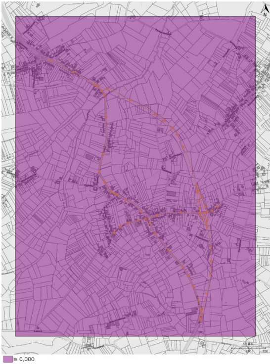
Figuur 3-9: Aantal overschrijdingen uurgemiddelde grenswaarden NO 2 voor het gewestplantracé (zonder ombouw van de N42 in het noorden) volgens IMPACT berekeningen
