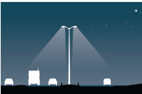
Figuur 5-3: Lichtmasten middenberm (links 12m) - Bron: Lichtvisie Gewestwegen 2017
