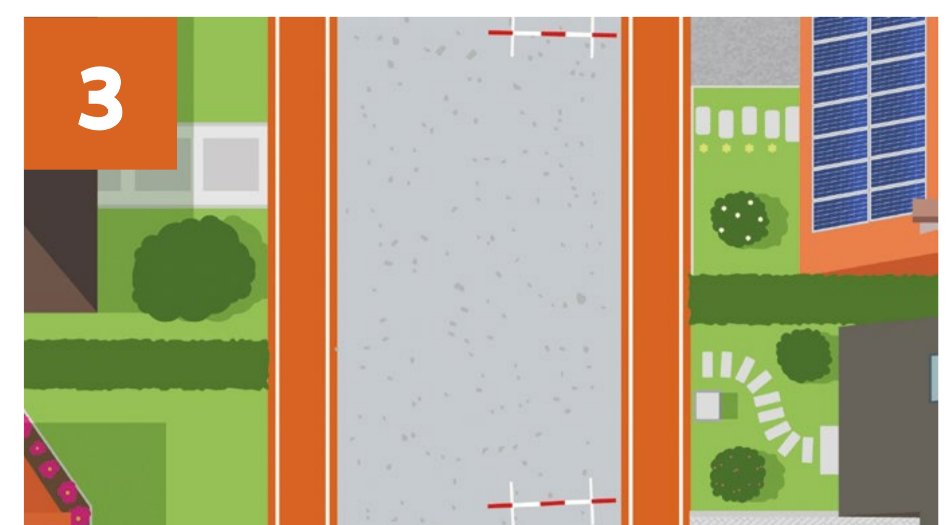
We behouden zolang mogelijk de bestaande verharding van de rijbaan en breken enkel de noodzakelijke zone op.
