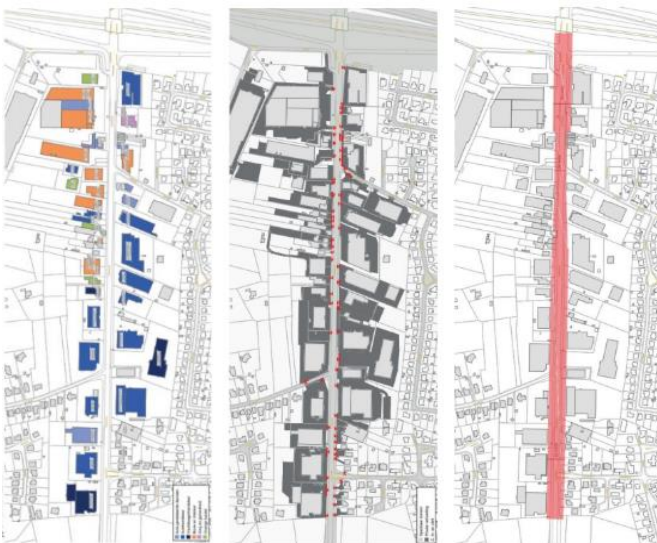
De analyse van de huidige situatie, met van links naar rechts: de beschikbare ruimte en de verharding, de 'conflicten' (waar bijv. fietsers in conflict komen met automobilisten), de fietspaden.
